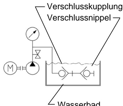
Prüfung 2: Verschlusskupplung entkuppelt
