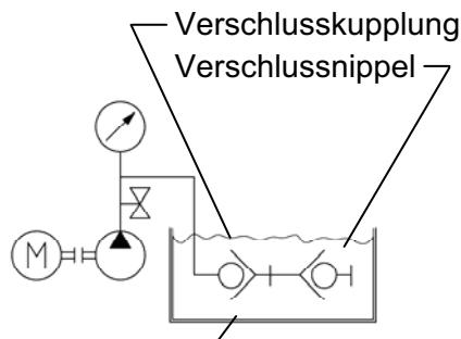
Prüfung 2: Verschlusskupplung entkuppelt
