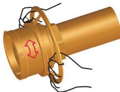
Loshälften (Nippel) axial mittig auf das Steckerteil der Festhälfte (Kupplung) aufschieben, bis fühlbarere Widerstand entsteht.
