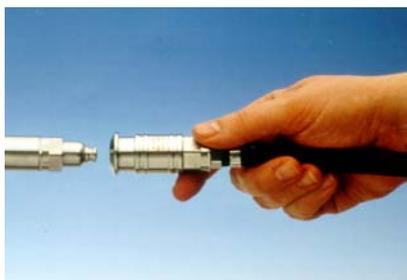
Falls dabei die Kupplungsachse zur Nippelachse nicht fluchtet (schräger Ansatz), so zentriert sich die Kupplung mit etwas Tastgefühl mit ihrer Führungslänge selbst,
